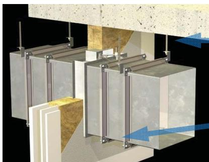
starr befestigte Luftleitung, mit schräger Abstützung ab  $H > 500\text{mm}$ ;
