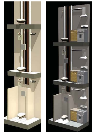
Bild 1 — Systematische Darstellung von Lüftungssystemen für Wohnungen
